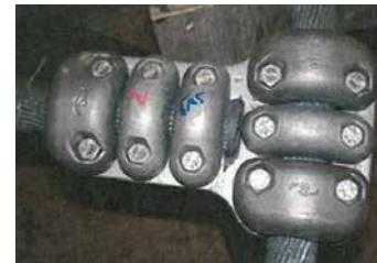
Випробування на корозію в камері соляного туману IEC 60068-2-11
