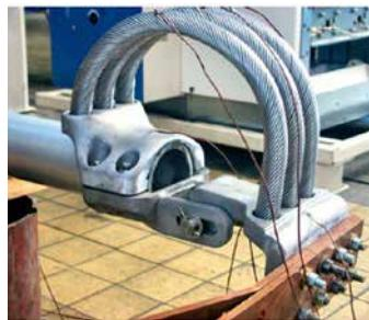
Випробування стримом короткого замикання IEC 62271-1 §6.6
