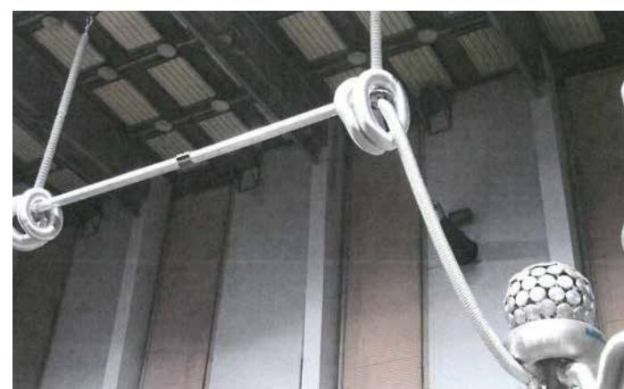
Випробування на корону та радіоелектронні перешкоди IEC 62271-1 §6.9.1 & IEC 61284
