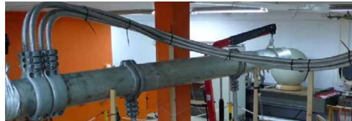
Випробування затискачів циклами нагрівання та охолодження ANSI/NEMA CC1 §2.6 §3.1, ANSI C119.4
