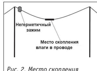
Рис. 2. Место скопления влаги в СИП
