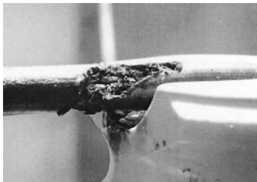
Рис. 4-5: Трекинг покрытия провода
