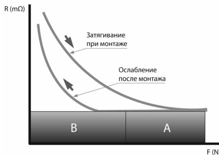
Рис. 4-9: Явление ослабления в соединителе: (А – зона стабильного сопротивления; В – зона повышения сопротивления)
