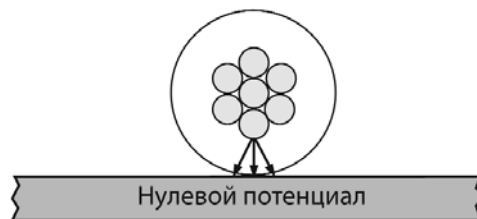
Рис. 2-3: Электромагнитная напряжённость между неуплотнёнными проволоками [3]
