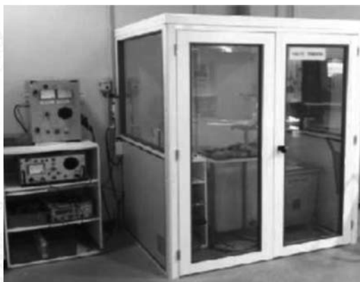
Рис. 45. Испытание на диэлектрическую прочность
