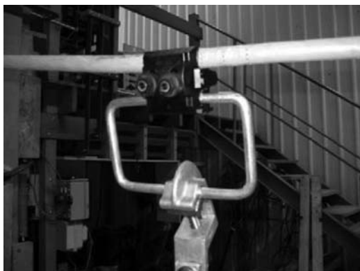
Рис. 14. Испытание устройства заземления на короткое замыкание
