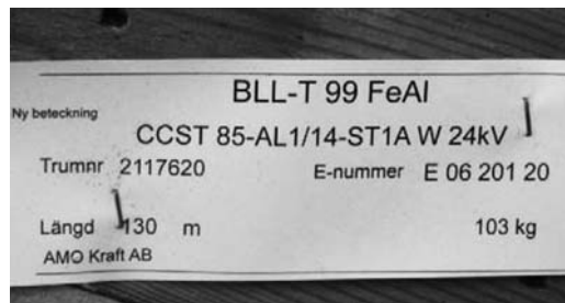
Рис. 16. Маркировка провода ВЛЗ на барабане
