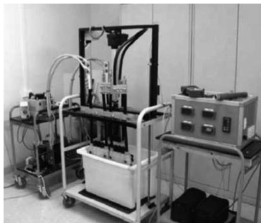
Рис. 47. Испытание на циклические механические нагрузки
