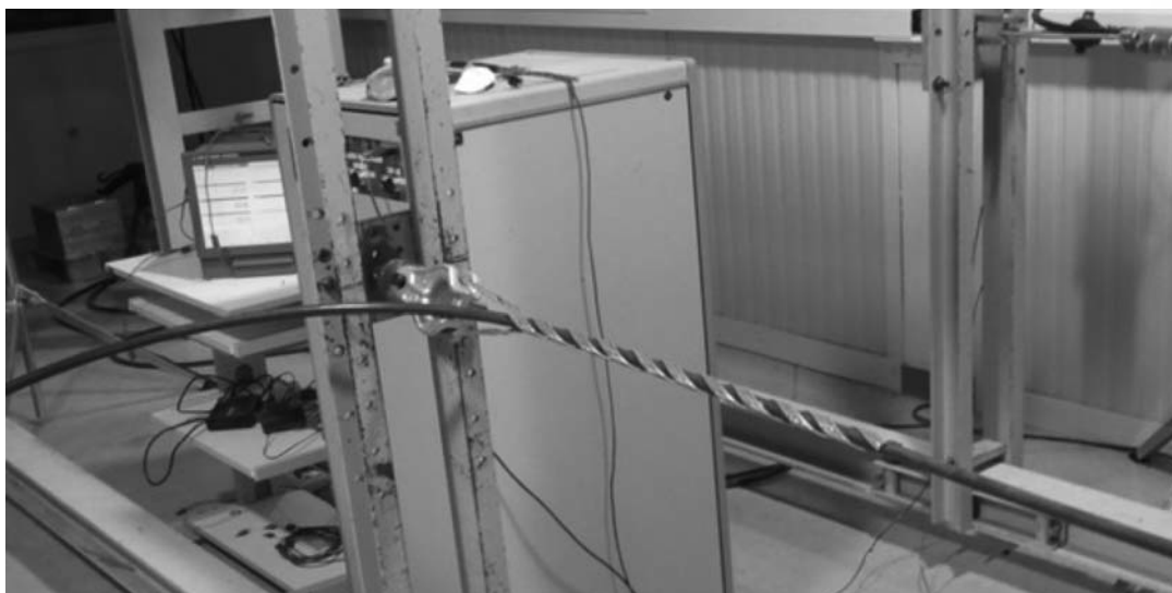
Рис. 5. Испытание на растяжение со спиральным зажимом
